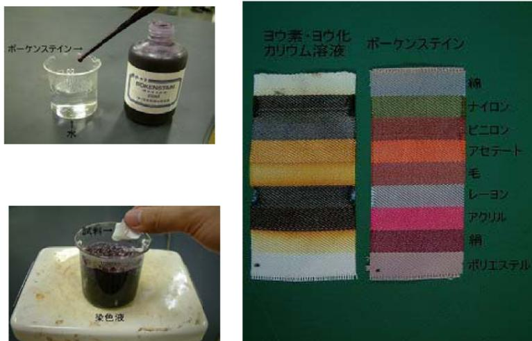
[그림 2] 보켄스타인 섬유 감별액으로 다섬교직포를 염색한 경우 및 요드·요드화칼륨 용액에 의한 염색
